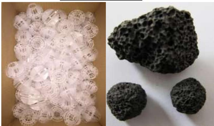
图 5.2-2 预洗池和生物滤池配套填料样品
