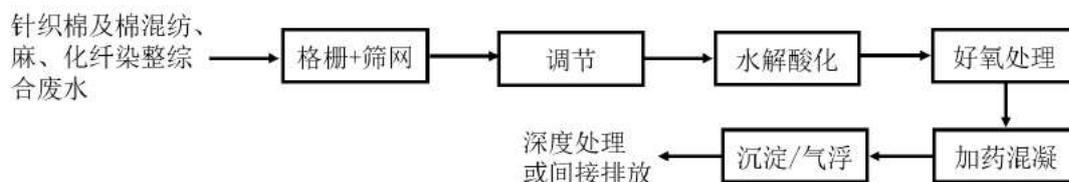
图 5.2-6 针织棉及棉混纺染整、麻染整以及化纤染整综合废水常规处理工艺流程图
